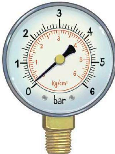
Dibujo 7: Manómetros. De rango superior a la presión máxima de la bomba.
