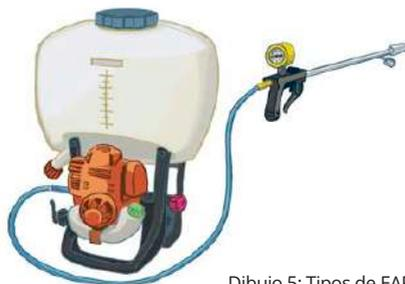
D: EAPF tipo pulverizador hidráulico de mochila
