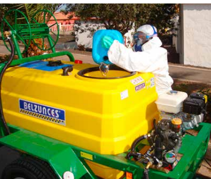
Revisar el equipo antes de utilizarlo; usar siempre agua limpia.
